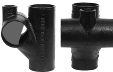
Parte No. NH 463 Cruz Para Inodoro Con Ventilación Superior de 2" (Diseñada para usarse por debajo del nivel del suelo; la Conexión tiene un deflector.)
