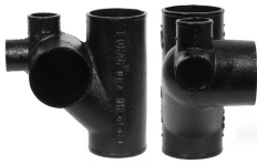
Parte No. NH 458 Tee Para Inodoro Con Ventilación Superior de 2" y Salida Lateral de 2" (Mano Izquierda o Mano Derecha; Diseñada para usarse por debajo del nivel del suelo; la Conexión no requiere deflector.)
